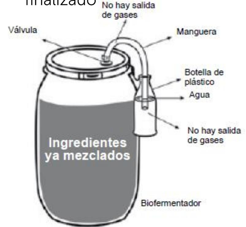
Recipiente con el biopreparado listo para usar después de 20 a 30 días de haber fermentado (observar salida de gases paralizada)
