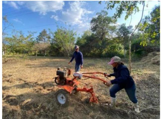
Estas máquinas han sido diseñadas para soportar los trabajos de campo más duros y pesados, la calidad de esta máquina hace posible su durabilidad y eficacia, funcionando a pleno rendimiento en las condiciones más extremas, con capacidad de mover suelo hasta 15 cm de profundidad. La velocidad de giro se mantiene entre 200 y 300 rev/min. También se les incorporan unos tráileres para convertirlos en remolques, que pueden llegar a ofrecer capacidades de hasta 1500 kg de carga.
