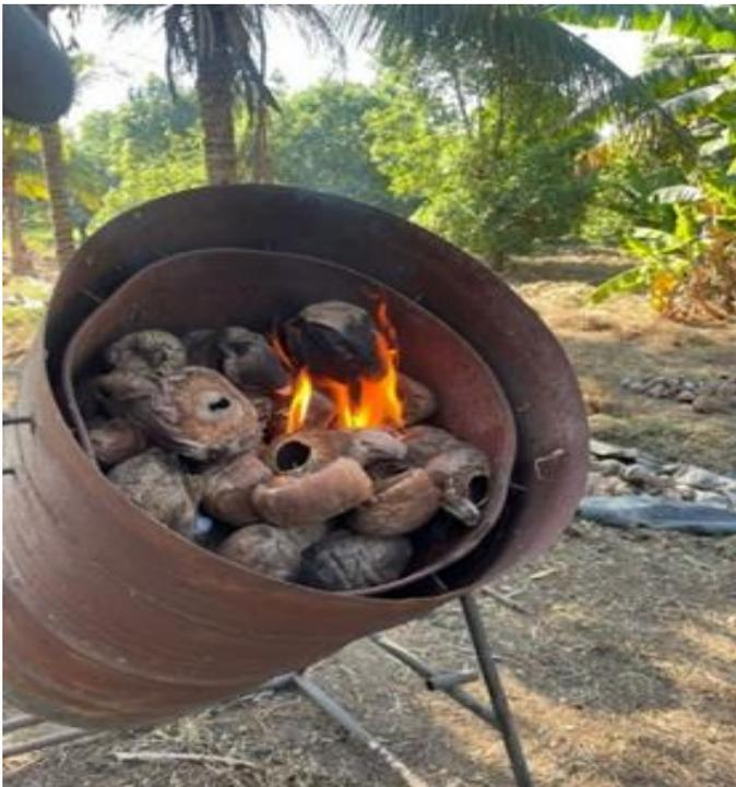
La producción de biocarbón se genera a partir de una pirólisis incompleta, la cual se caracteriza por tasas de calentamiento bajas, en la que ocurre una descomposición química de la materia orgánica e involucra cambios simultáneos del estado físico, los cuales son irreversibles.
