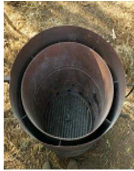
Este proceso consiste en hacer uso eficiente de los materiales y equipos necesarios para la producción del biocarbón, entre ellos reactor (compuesto por dos cilindros de metal, un mango de 30 cm para girarlo) y parrilla (formada por varillas de metálicas, colocada en la base del reactor, permitiendo la entrada de oxígeno), termómetro láser tipo pistola de -40 a 650 °C con efectividad lectora, guantes
