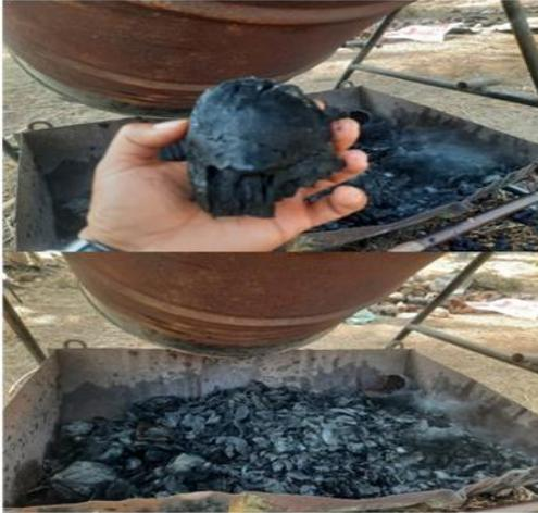
tales como: toma de temperatura del reactor, peso de la carga, el tiempo de la descarga y la aplicación del agua al producto (para evitar la incineración).
